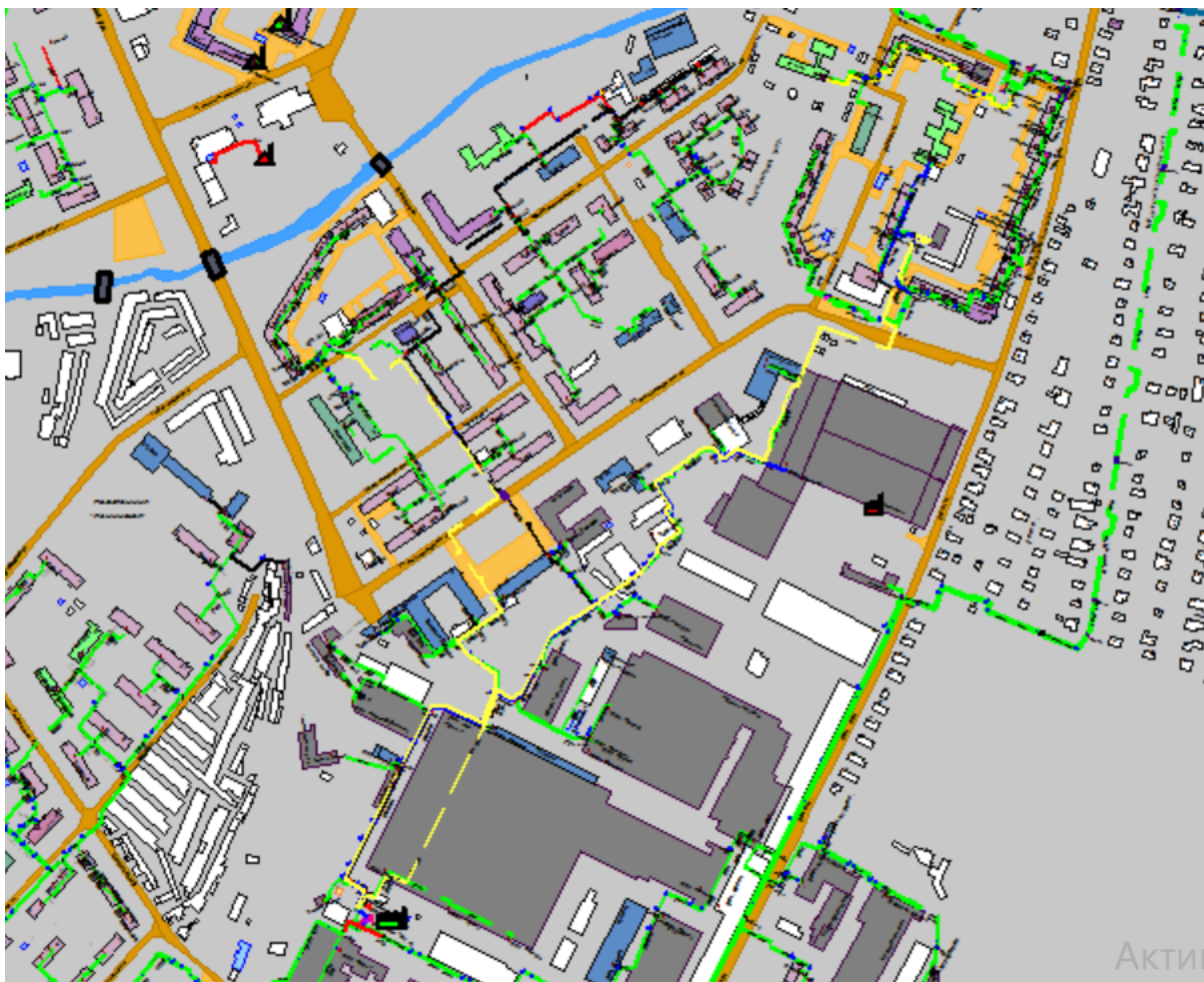
Рисунок 1.13 Результат гидравлического расчета - расчетный путь теплоносителя от котельной Памирская, 11 до ПТ-Сафрон, 15 вв2
