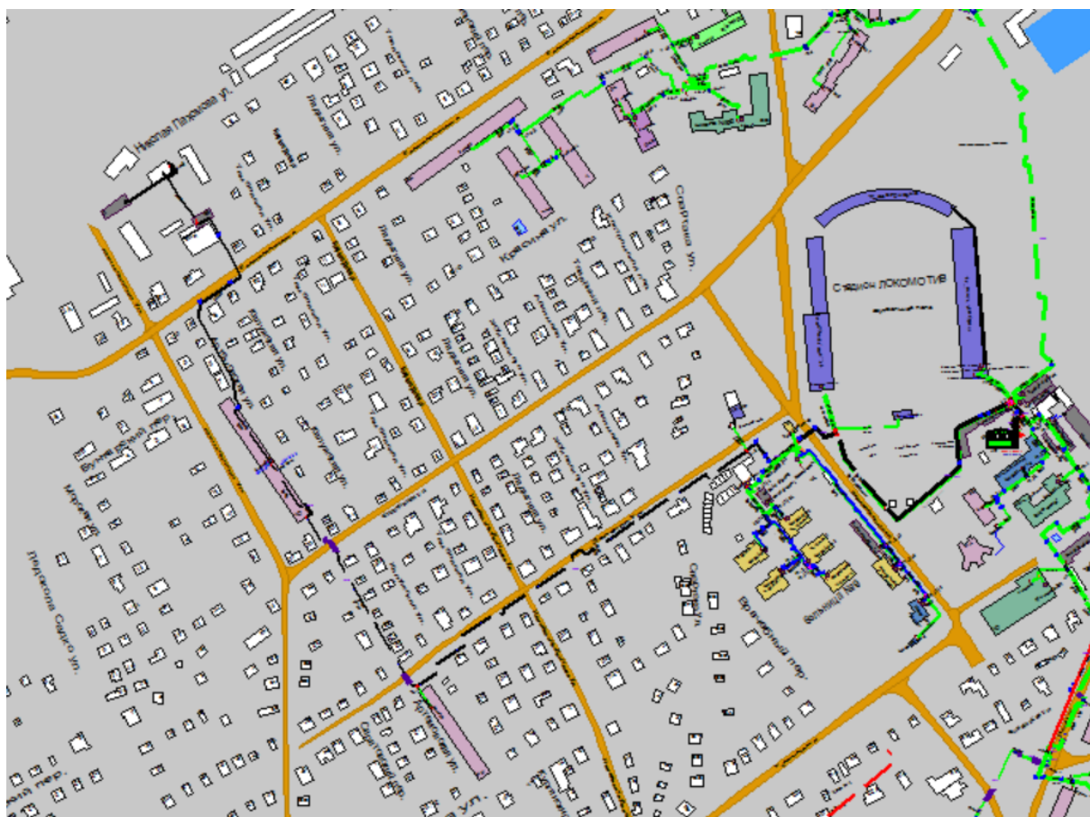
Рисунок 1.39 Результат гидравлического расчета - расчетный путь теплоносителя от котельной Климовская, 86а до ПТ-Клим,3
