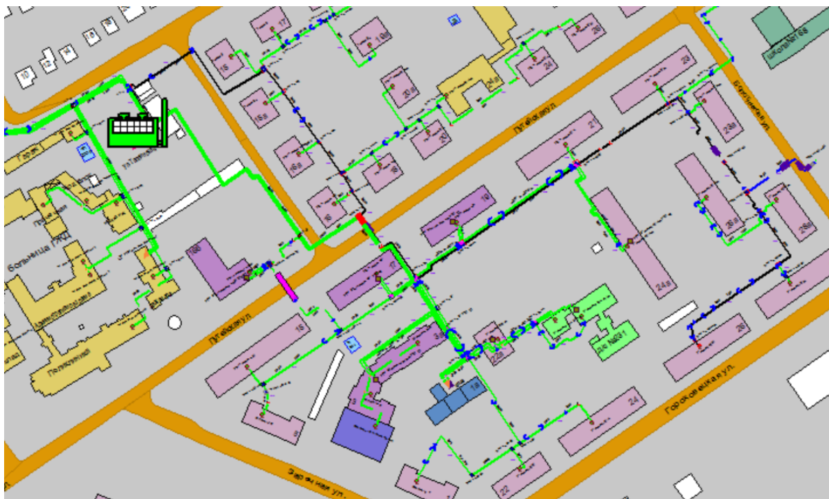
Рисунок 1.99 Результат гидравлического расчета - расчетный путь теплоносителя от котельной Таллинская, 15в до ПТ-Горох,26
