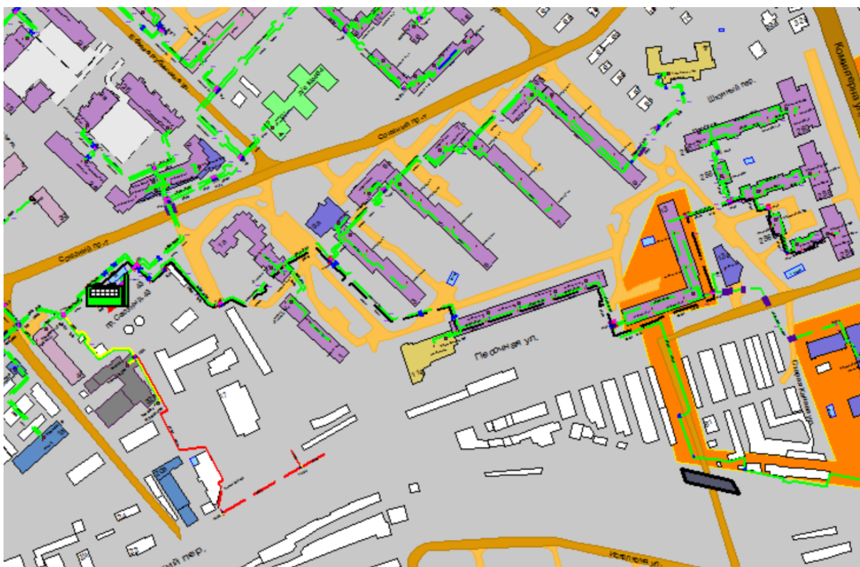
Рисунок 1.61 Результат гидравлического расчета - расчетный путь теплоносителя от котельной пр. Союзный, 43 до ПТ-Комин,256 э2
