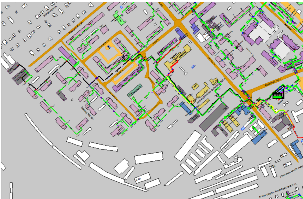
Рисунок 1.65 Результат гидравлического расчета - расчетный путь теплоносителя от котельной пр. Союзный, 43 до ПТ-Замкнут,15 э3
