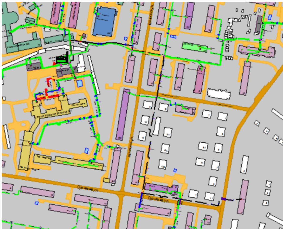
Рисунок 1.45 Результат гидравлического расчета - расчетный путь теплоносителя от котельной пр. Гагарина, 70а до ПТ-Корейск,4
