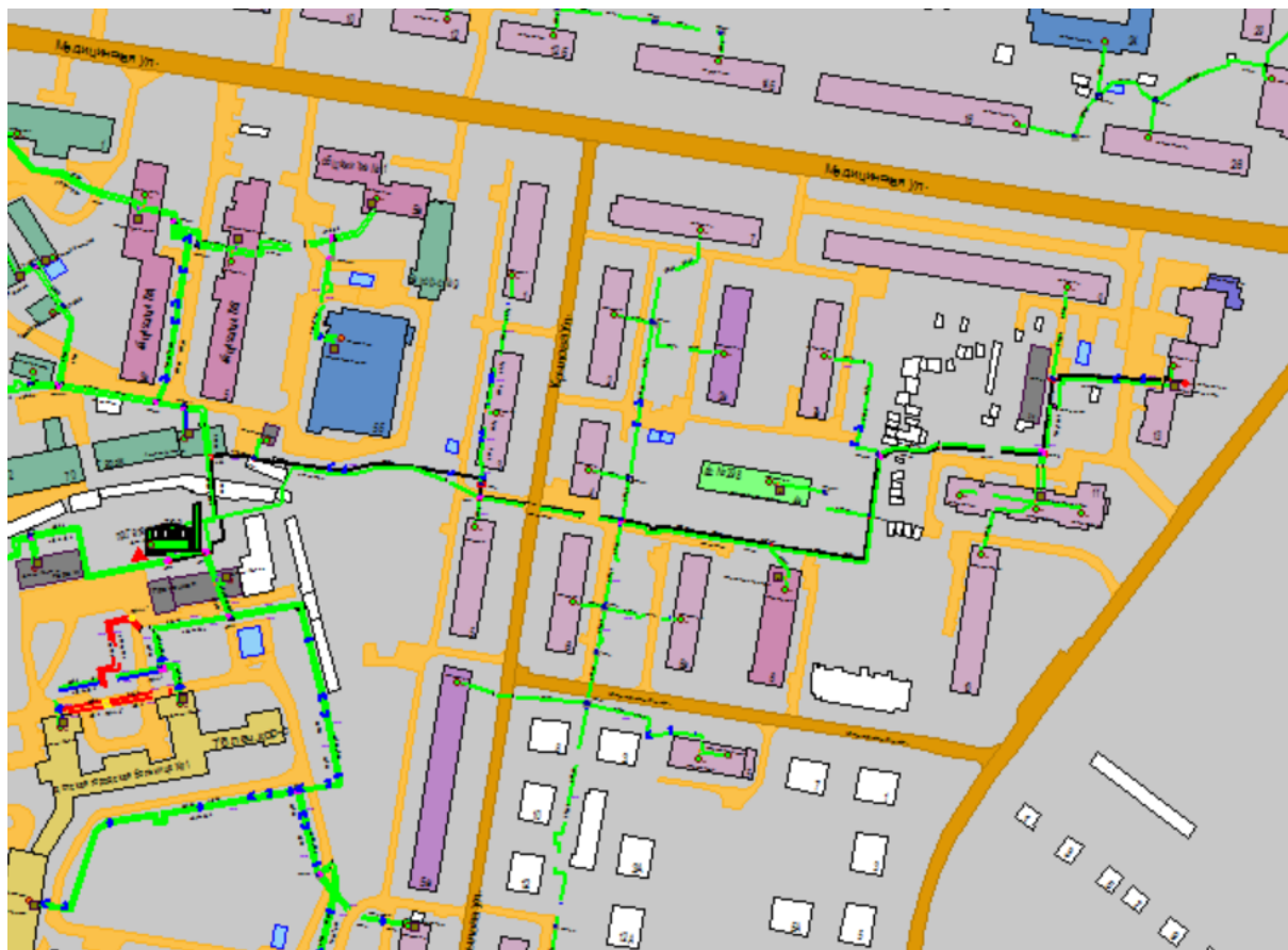
Рисунок 1.47 Результат гидравлического расчета - расчетный путь теплоносителя от котельной пр. Гагарина, 70а до ПТ-Медицин,13 э1
