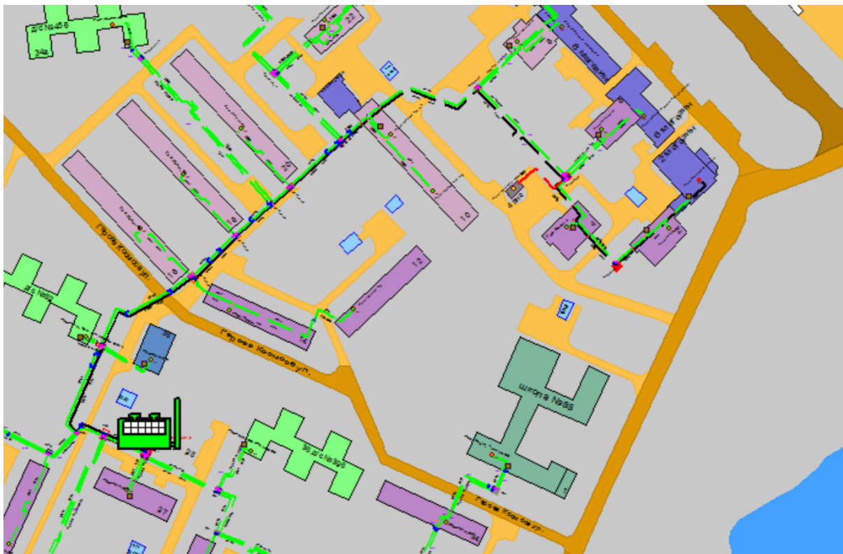
Рисунок 1.73 Результат гидравлического расчета - расчетный путь теплоносителя от котельной ул. Гаугеля, 25 до ПТ-Гаугеля,1 до ПТ-Гер.Косм,2 кафе
