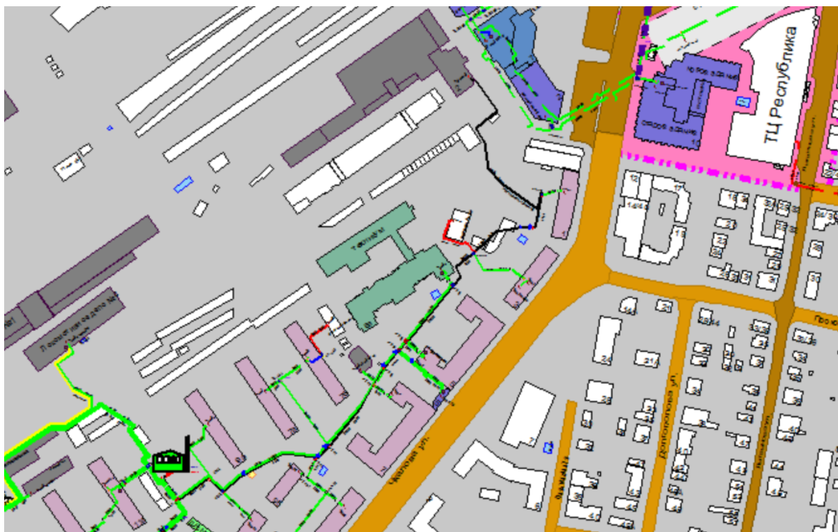
Рисунок 1.95 Результат гидравлического расчета - расчетный путь теплоносителя от котельной Чкалова, 9д до ПТ-Революц.пл,2
