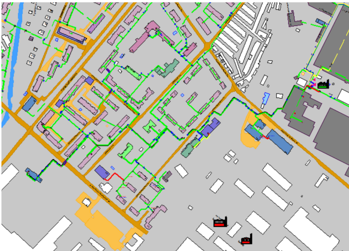
Рисунок 1.17 Результат гидравлического расчета - расчетный путь теплоносителя от котельной Лесной городок, 6в до ПТ-Вторчер,6а
